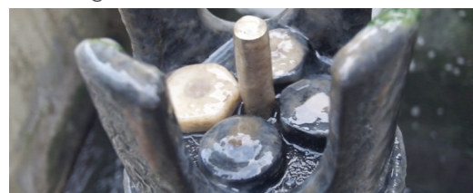
Abbildung 5: VARiON Sensor nach sechs Wochen kontinuierlichen Betrieb in einem anoxischen Bioreaktor
